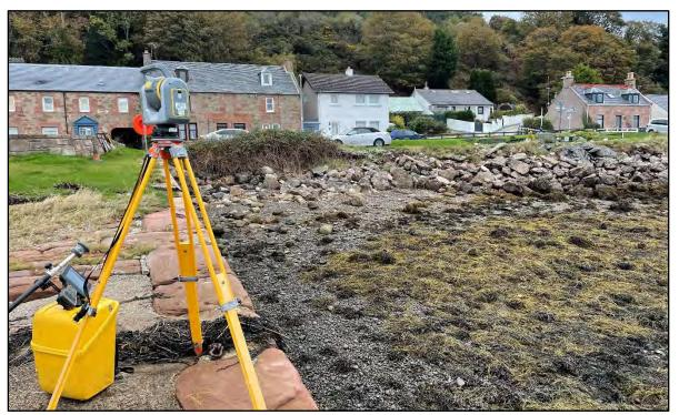
FIGURE 3 - SX10 LASER SCANNER SETUP
