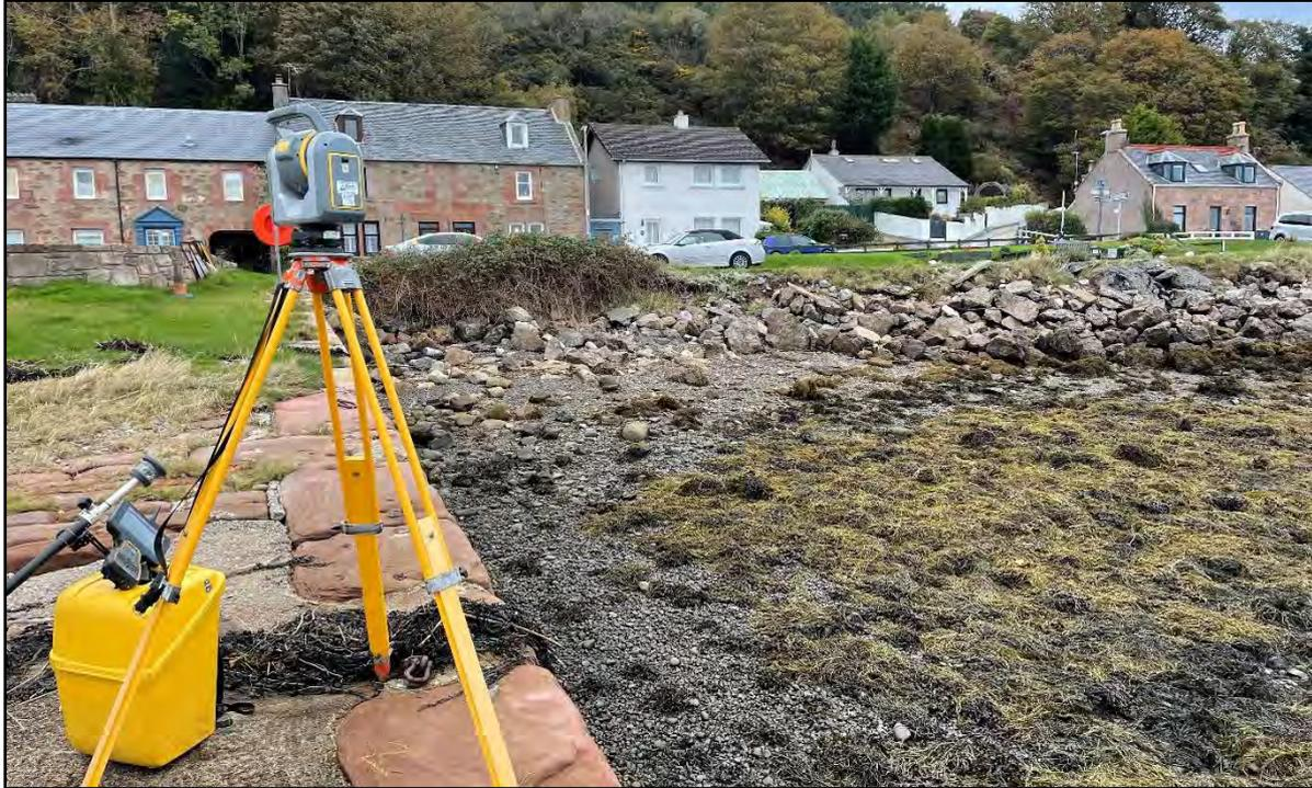
FIGURE 3 - SX10 LASER SCANNER SETUP
